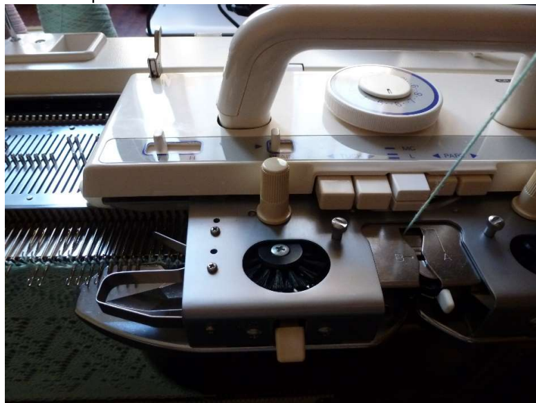
Установка режима вязания SLEEP
