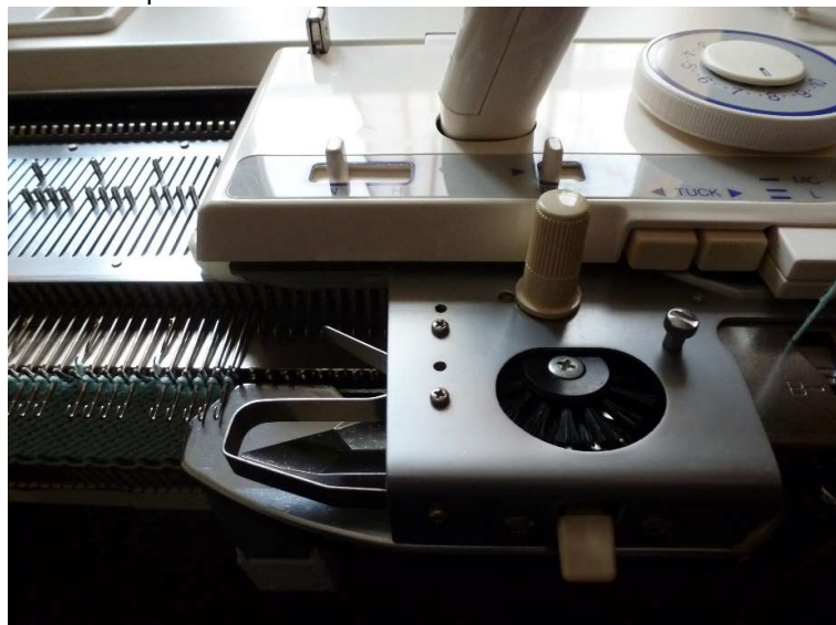
Установка режима вязания TUCK
