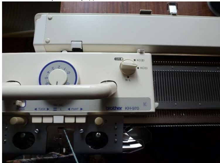
Положение каретки перед началом вязания
